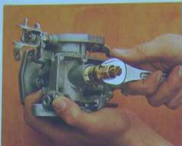
2 CDS: sproeierhouder losdraaien
