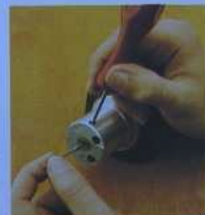
2 Klamschroef losdraaien
